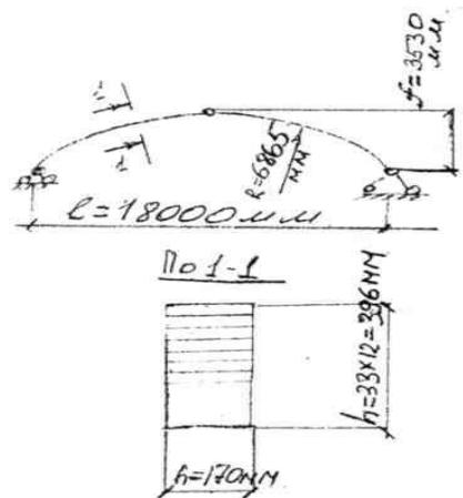
7. Проверить сечение трехшарнирной дощатоклееной арки покрытия при следующих исходных данных:
