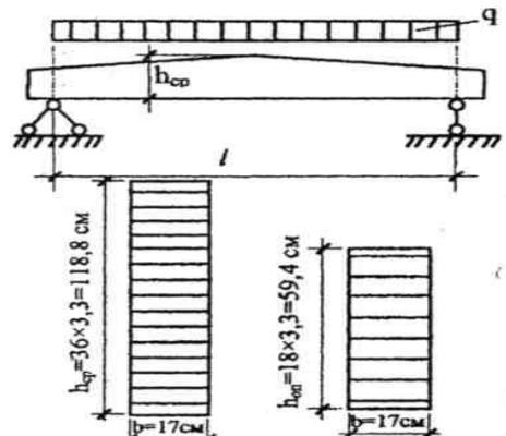
9. Проверить из условий устойчивости сжатой обшивки и прогиба несущую способность кле-фанерной плиты.
