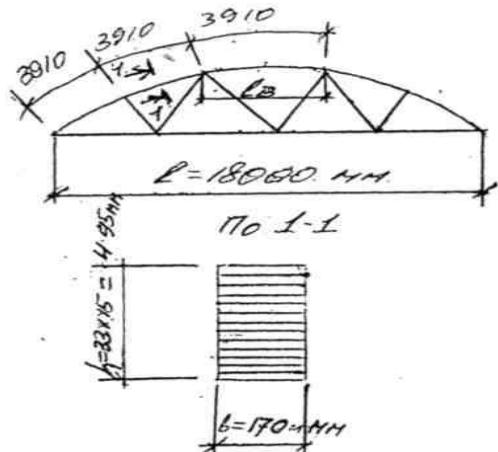
6. Проверить сечение трехшарнирной дощатоклееной арки покрытия при следующих исходных данных:
