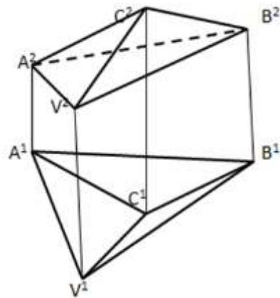
10. Построить графическое отображение в виде трех проекций пирамиды с призматическим вырезом.
