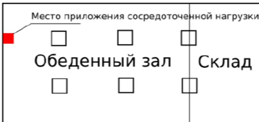
Определить усилия в раме. На ригели действует вес от плит перекрытия, стяжки, отделки пола и полезная нагрузка.
