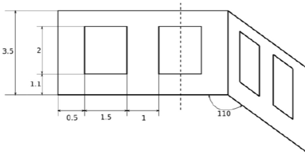
Найти напряжения в плите. К плите приложены постоянные и временные нагрузки (вес стяжки, отделки, полезная нагрузка по СП). По контуру колонн опоры – жесткая заделка.
